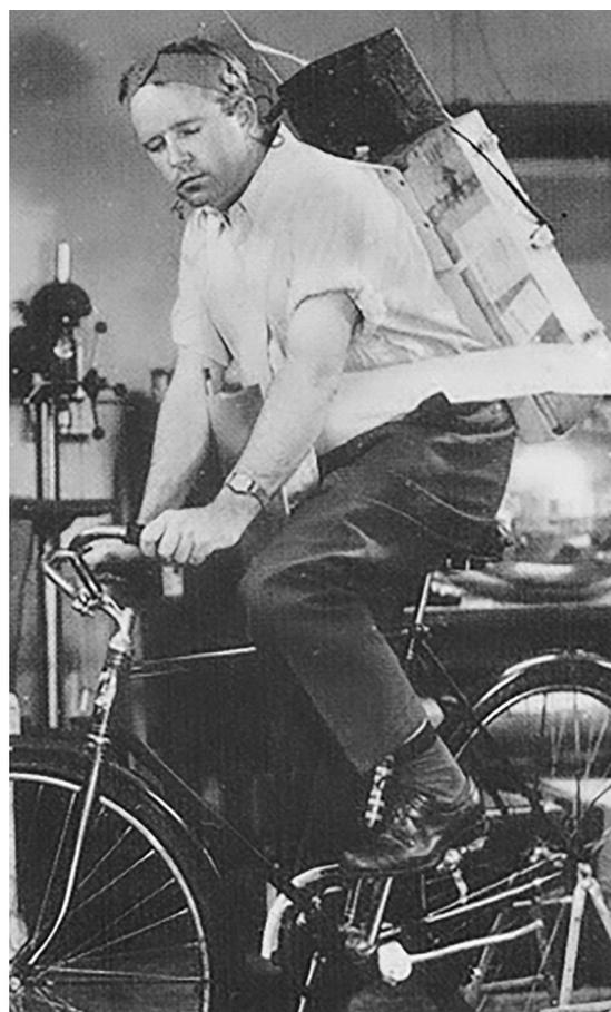
Рис. 2. Оригинальный биотелеметрический аппарат Холтера 1947 г. выпуска. Использовался для трансляции электроэнцефалограммы и электрокардиограммы с использованием грубого тяжелого аккумуляторного оборудования весом почти 40 кг [1]
