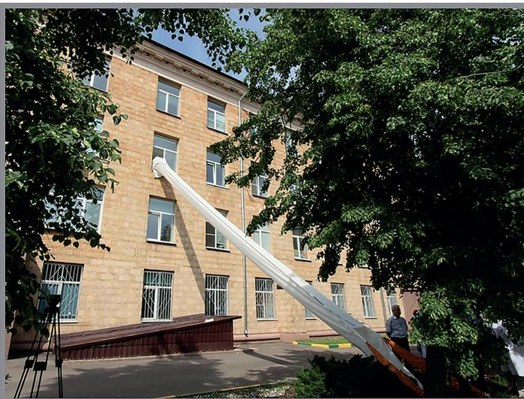
Рис. 5. Наклонный спасательный рукав
